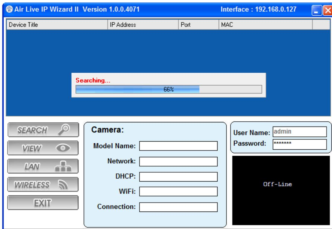
Kameranın IP adresi LAN ile aynı IP segmentinde ise, IP Kameranın üzerine çift tıklayın. Ardından, varsayılan tarayıcı görünecektir ve otomatik olarak IP kameranın Web'e yüzü açılacaktır.
