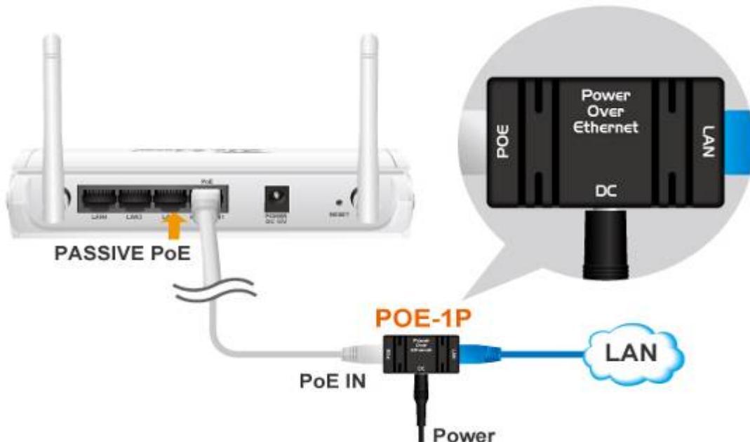
Cihazlarda herhangi bir ayar ihtiyacı bulunmamaktadır. Cihazlar yukarıda belirtildiği şekilde bağlanır. POE-1P cihazının PoE IN portuna bağlanan ethernet kablosunun diğer ucunu PoE pasif porta sahip cihazınıza bağlayınız. POE-1P cihazınızın diğer Ethernet portuna bağlanacak başka bir ethernet kablosu ile de yerel ağınıza bağlantı yapabilirsiniz.
