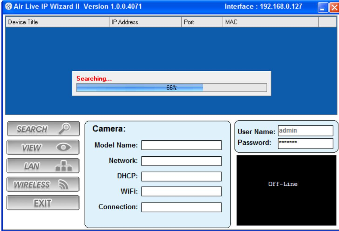
Kameranın IP adresi LAN ile aynı IP segmentinde ise, IP Kameranın üzerine çift tıklayın. Ardından, varsayılan tarayıcı görünecektir ve otomatik olarak IP kameranın Web'e ara yüzü açılacaktır.
