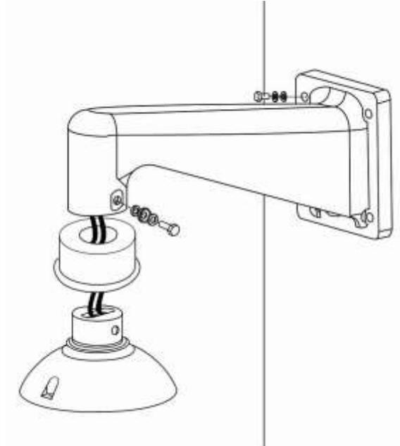
Standart Duvar Dağı ile AirLive SD-2020 monte için aşağıdaki adımları izleyin.
