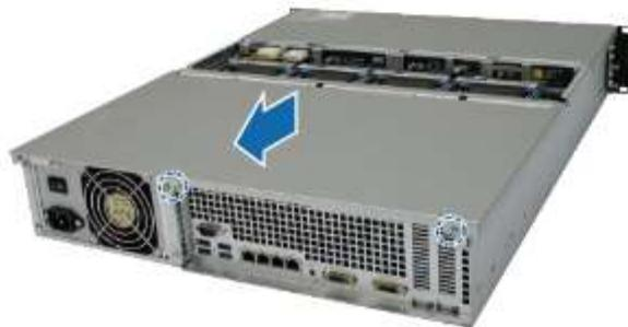
c Tespit braketinin vidalarını söküün ve RAM yuvalarını açığa çıkartmak için tespit braketini çıkartın.
