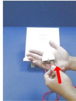
**Paso 8:** Enchufe el cable Ethernet al punto "P + DATA OUT" del Inyector PoE.
