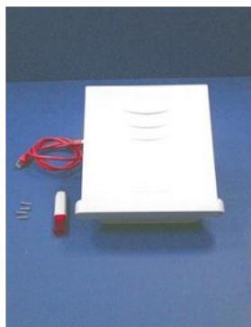
1. Szüksége lesz csavarhúzóra, ethernet kábelre, 4 csavarra és a WH-5420CPE
