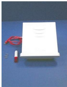
**Krok 1:** Odšroubujte všechny čtyři šrouby a odpojte síťový kabel zařízení WH-5420CPE
