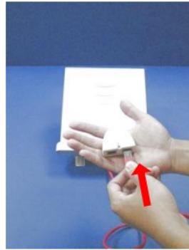
**Passo 8:** Ligue o cabo de rede ao jack PoE 'P + DATA OUT do injector
