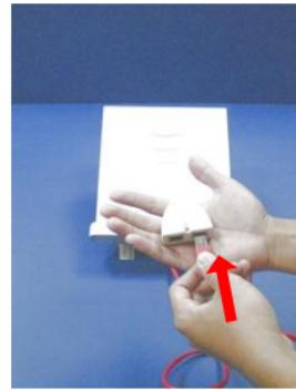
8. Dugja be a hálózati kábelt a kiegészítő modul PoE „P+DATA OUT” csatlakozójába
