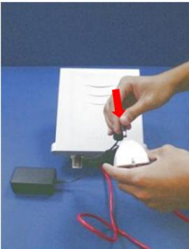
**Paso 9:** Enchufe el cable de AC del adaptador al punto "POWER IN" del Inyector.
