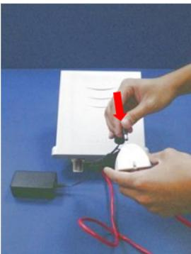
**Krok 9:** Podłącz kabel zasilacza do gniazdko „POWER IN”.
