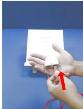
**Paso 8:** Enchufe el cable Ethernet al punto "P + DATA OUT" del Inyector PoE.
