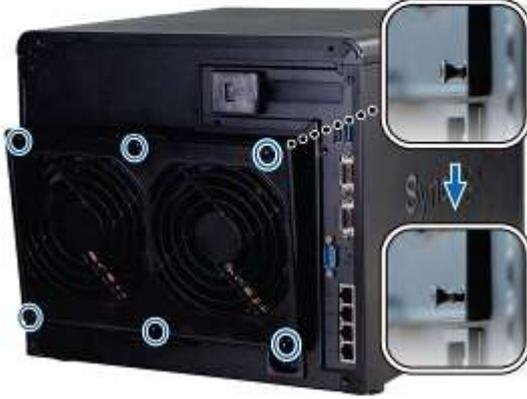
3 Arızalı fan modülünü sökmek için, DiskStation sunucunuzdan çıkartmanız gerekir.
