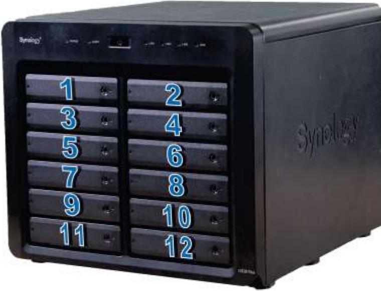
**Not:** Bir RAID birimi oluşturmak isterseniz, sürücü kapasitesinden en iyi şekilde yararlanmak için takılan tüm sürücülerin aynı büyüklükte olması önerilir.
