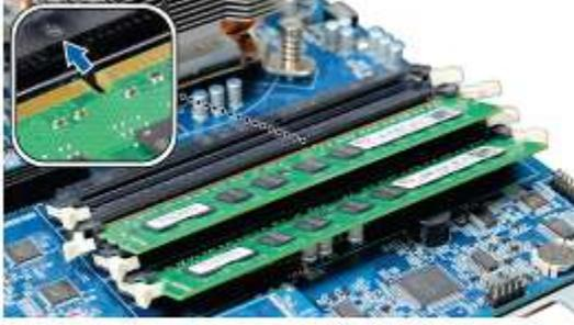
c Güçlü ve düzgün bir basınçla bellek modülü üzerine bastırın. Tespit klipsleri modül doğru takıldığında yerlerine oturur.
