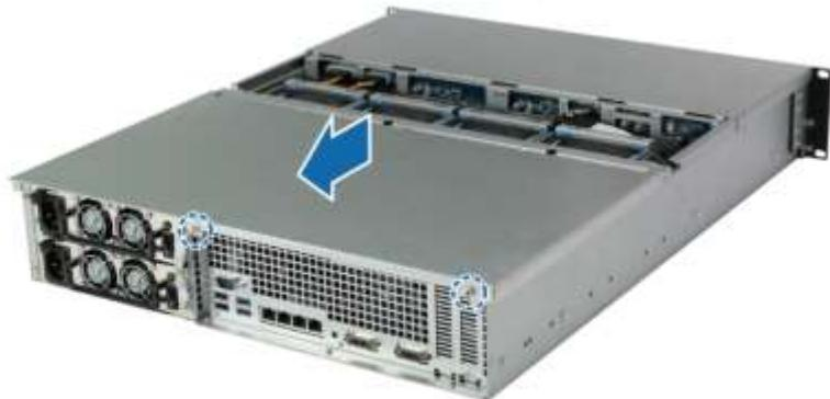
c Tespit braketinin vidalarını sökün ve RAM yuvalarını açığa çıkarmak için tespit braketini çıkartın.
