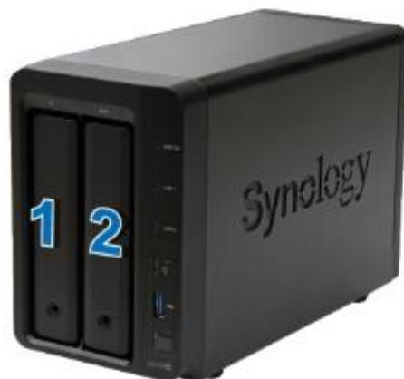
**Not:** Bir RAID birimi oluşturmak isterseniz, sürücü kapasitesinden en iyi şekilde yararlanmak için takılan tüm sürücülerin aynı büyüklükte olması önerilir.
