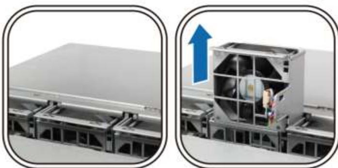
5 Elektrik fışına kuvvetlice bastırın ve aşağıda gösterildiği gibi güç bağlantı noktasından kaydırarak çıkartın. Ardından arıza yapmış fani, fan muhafazasından söküн.
