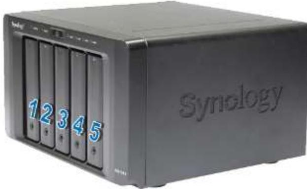
**Not:** Bir RAID birimi oluşturmak isterseniz, sürücü kapasitesinden en iyi şekilde yararlanmak için takılan tüm sürücülerin aynı büyüklükte olması önerilir.
