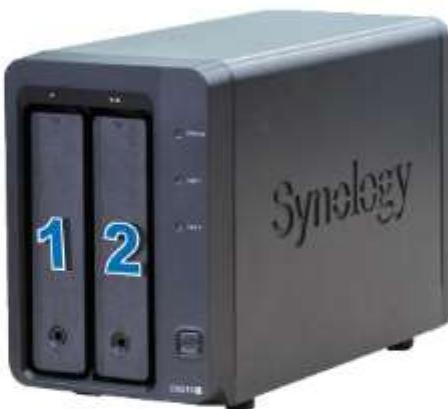
**Not:** Bir RAID birimi oluşturmak isterseniz, sürücü kapasitesinden en iyi şekilde yararlanmak için takılan tüm sürücülerin aynı büyüklükte olması önerilir.
